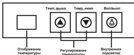
Температурный диапазон термоэлектрического холодильника составляет 10–18 °С. При достижении заданной температуры внутри холодильника срабатывает автоматическая система контроля температуры, а система охлаждения переходит в режим линейного поддержания температуры.
